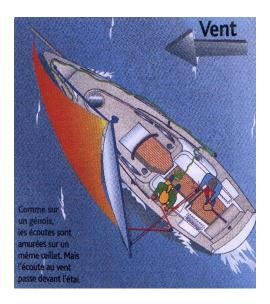
**Au largue**, il ne faut pas laisser le point d'amure aller sous le vent. <u>Le point d'amure doit être repris jusqu'à la poulie</u>, (quitte à lâcher un peu de drisse). Sinon, l'ensemble du spi bascule vers l'arrière et fait gîter le bateau lieu de le faire avancer.
