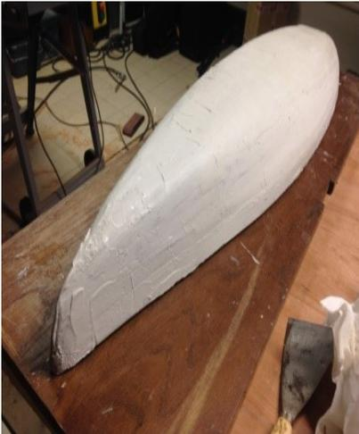
prototype a commencé à prendre visage nautique... Certes l'aspect n'est pas si beau, mais un peu d'huile de coude lui donnera la finesse et la délicatesse que nous espérons. Une bonne couche d'enduit de finition et pas mal de ponçage, voilà ce dont a besoin notre coque. Après pas mal d'heures de ponçage et enduisage, le « positif » me semble prêt à être utilisé pour réaliser le moule.
